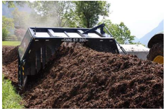
Figure 3 e 4. Operazione di rivoltamento dei cumuli di letame attraverso macchina rivoltatrice durante l'uscita in Val di Ledro del 27 maggio 2022
